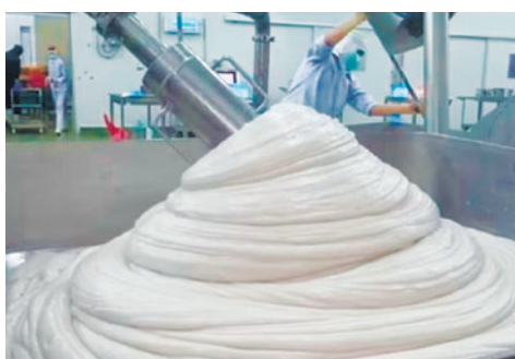
Замороженные блоки рыбьего мяса пропускают через машину и измельчают до образования серой пасты
